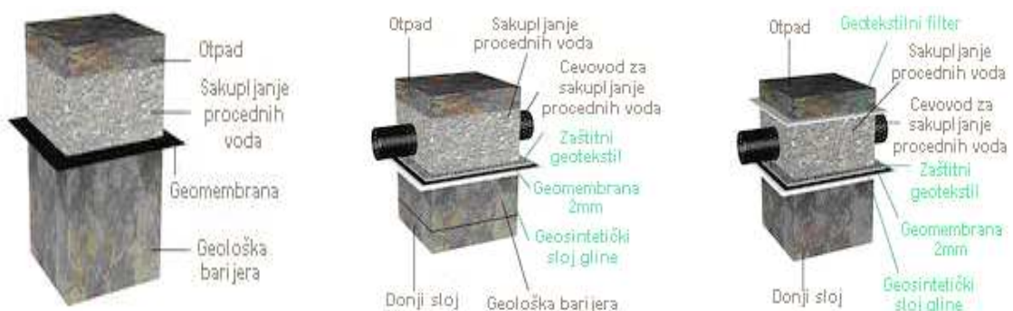
Слика 5.23. Приказ доњих слојева депоније
