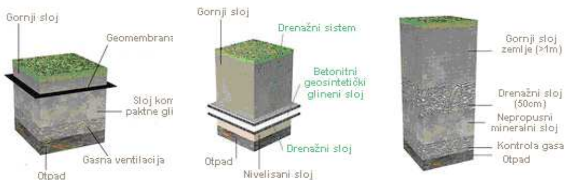
Слика 5.19. Приказ горњих покривних слојева депоније
