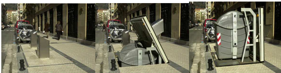
Слика 6.6. Подземни контејнери са пражњењем возилима са бочним или задњим утоваром зависно од капацитета
