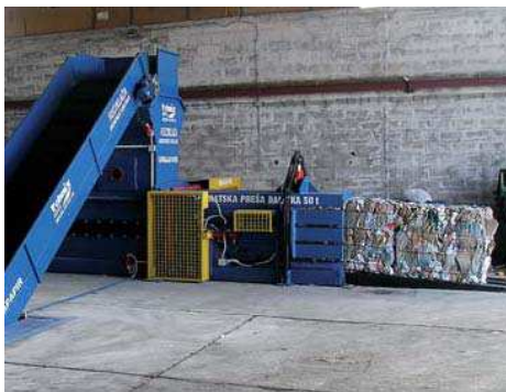
Слика 6.15. Простор са хоризонталном пресом за пресовање и балирање отпадних материјала
