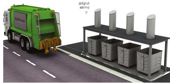
Слика 6.9. Пример подземних контејнера са сабирницима
