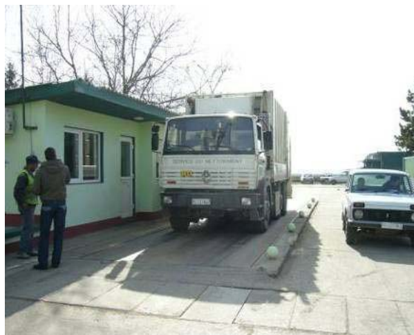
Слика бр.8: Мерење тежине камиона на колској ваги
